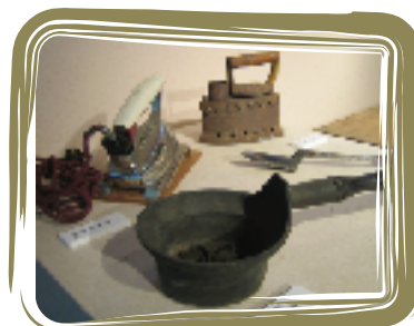
手前から時計回りに、火熨斗・電気アイロン・炭アイロン・焼きゴテ
